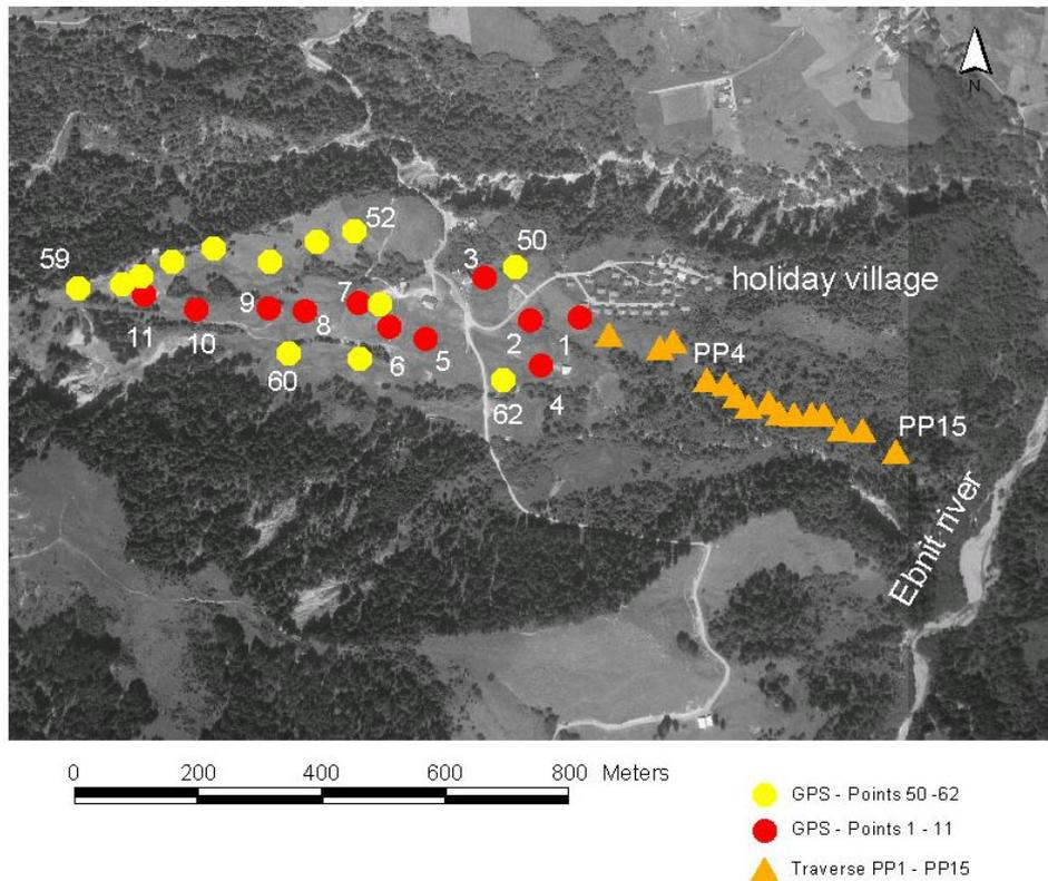
Fig. 3 “Heumöser Hang” with GPS and traverse points (source: Orthophoto, Bundesamt für Eich- und Vermessungswesen, 1990)
